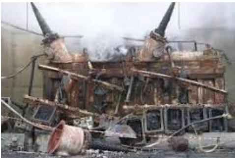
La principal **causa** de **incendio** en el interior de los **transformadores** con el aislamiento líquido de alta inflamabilidad es la pérdida de su capacidad aislamiento efectivo.
